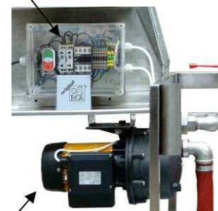
Abb.: Saug- und Druckpumpe
